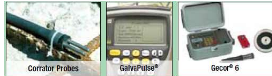
รูปที่ 4.3 การทดสอบโดยอาศัยเหล็กเสริมที่อยู่ในเนื้อคอนกรีต (ที่มา www.cortecmci.com )
